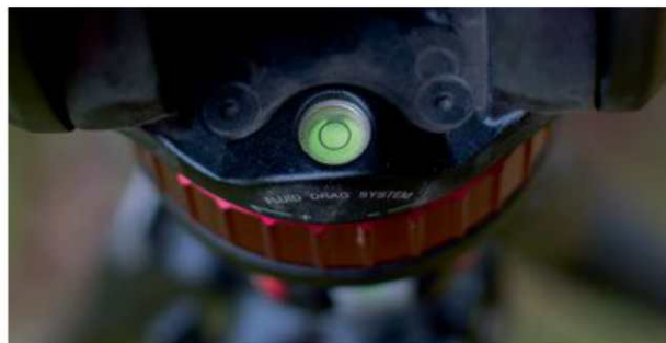
Autre indicateur du réglage du trépied : le niveau à bulle, souvent présent sur le trépied et les têtes fluides.
