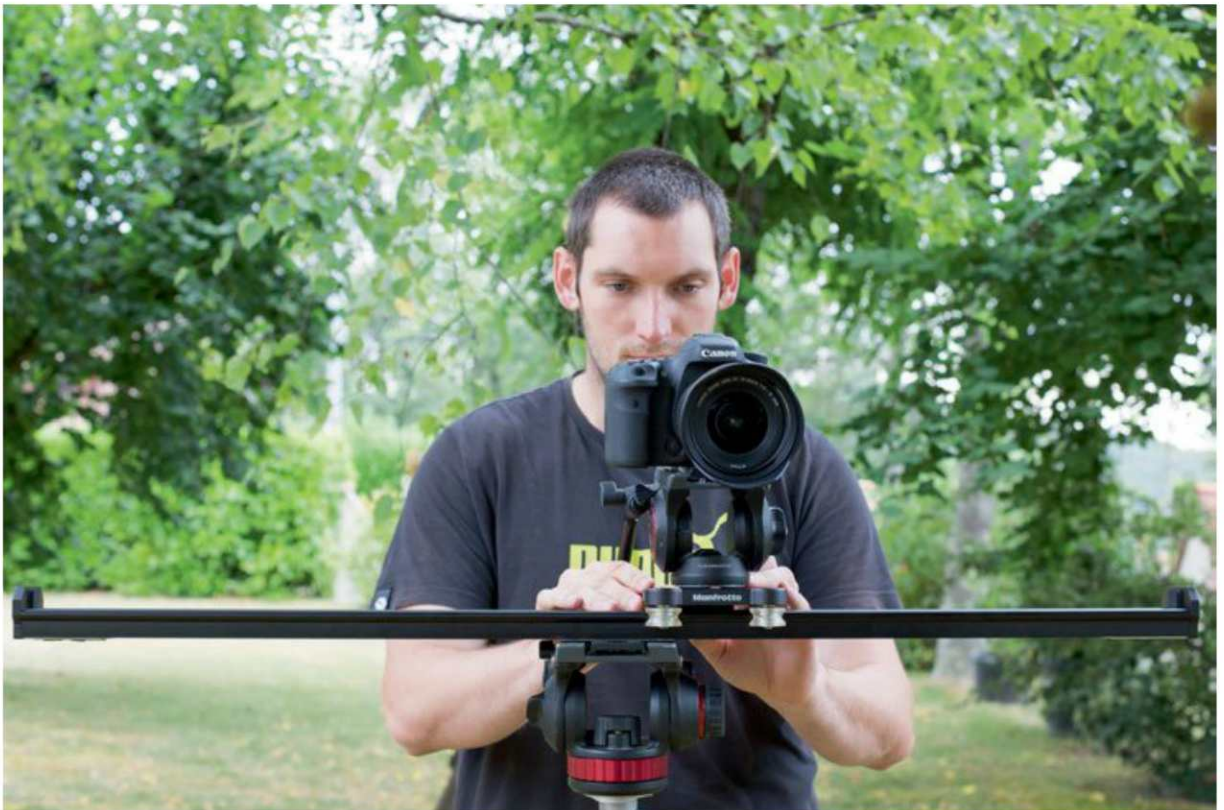
La barre de travelling vient se fixer sur le trépied. Elle permet de faire un mouvement de caméra sur toute sa longueur, et de manière très stable.
